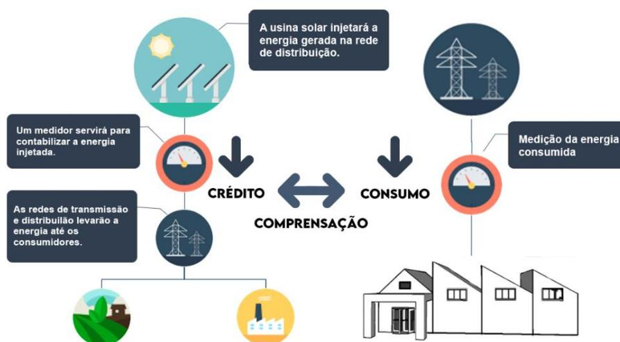
Figura 7 - Geração Remota - Sistema de Compensação de Energia.
