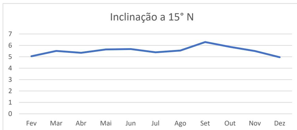
GRÁFICO 10 - Gráfico Irradiância local no plano inclinado igual a latitude (kwh/m²/dia)
